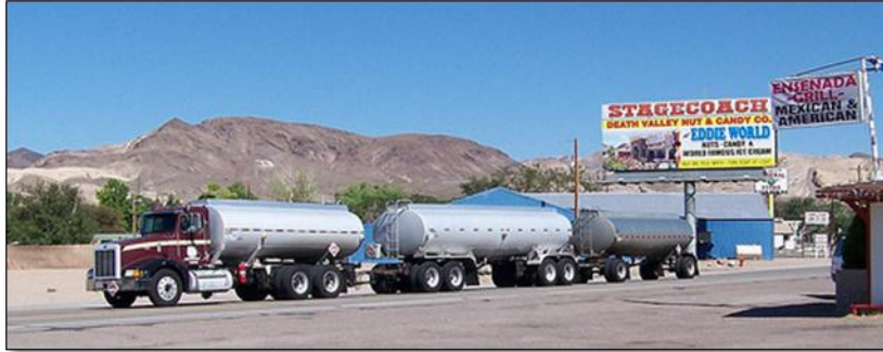
Figura 14. Camión con tráiler tipo tanque, para el transporte de líquidos Figura tomada de http://www.flickr.com
