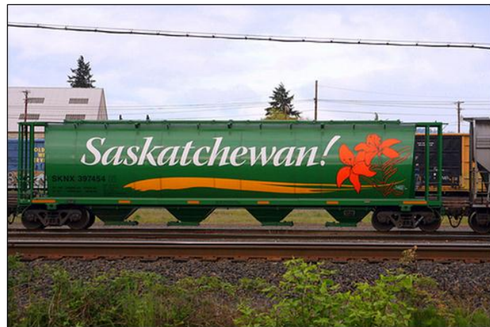
Figura 20. Tolva granelera para productos agroindustriales
