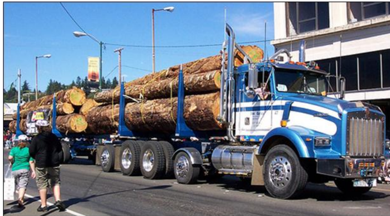
Figura 15. Camión con tráiler adaptado para el transporte de maderas Figura tomada de http://www.flickr.com
